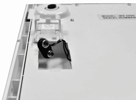
4. Instale la batería alcalina de 9V.
