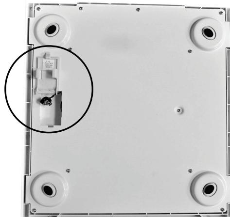
3. La báscula utiliza una pila alcalina de 9V.
