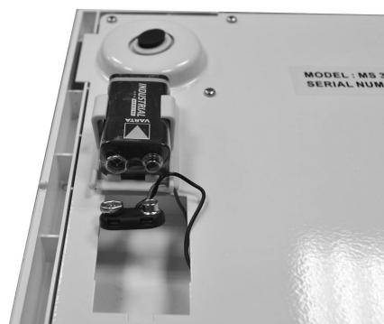
5. Replacer le logement de pile dans la balance pour terminer la procédure.
